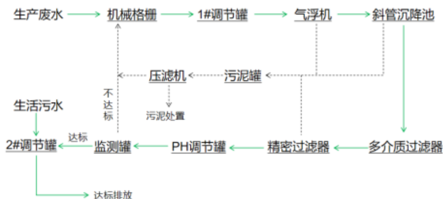
图 3.4-2 项目厂区废水处理工艺流程图
